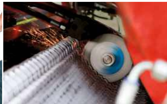
AUTO CUT – Vollautomatische Messerschleifeinrichtung direkt am Ladewagen.
